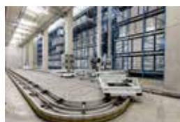
车)，在和存储通道垂直相交的母车轨道上运行，SUPERCAP（子车超级电容）在存储通道运行，并由超级电容进行供电。
