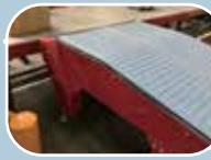
模组带爬坡输送机 模组带智能分拣系统解决方案
