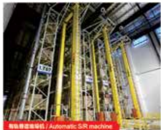
自动存取系统 / Automatic S/R machine
